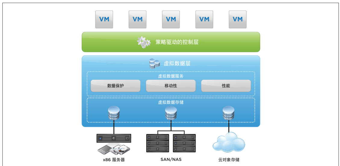
图 1：软件定义的存储体系结构
